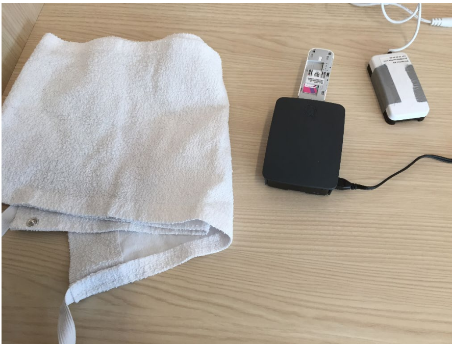
Bestanddelene i BALT-sengevakt: etui for å feste til madrassen, hub og sensor.
